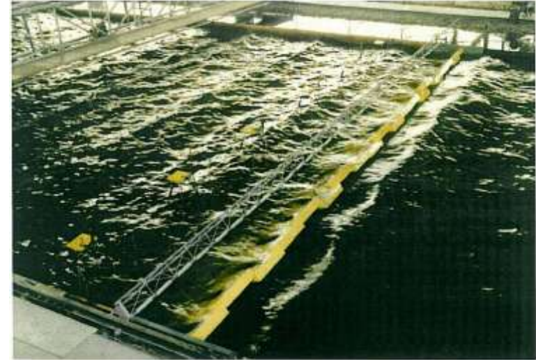
Sturmflutbauwerk Venedig: Modelluntersuchungen durch WL | Deift Hydraulics, 1988-1992
